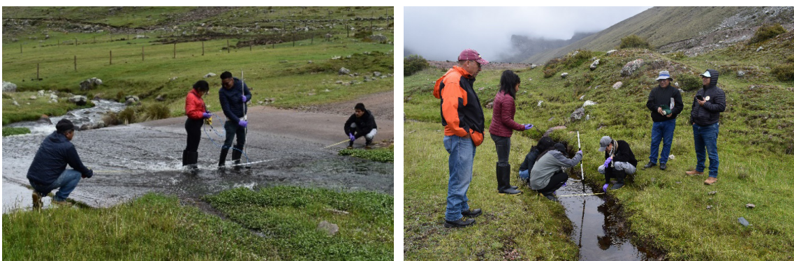
Figura 54. Izquierda: Río Huanta (Sitio Q2.3) - Personal y estudiantes de la UNAH utilizan el caudalímetro Valeport para recoger datos de velocidad de la corriente del río. Derecha: Río Iguian Huamangilla (Sitio 3.3) - Los estudiantes de la UNAH recogen datos característicos del río (velocidad) utilizando un caudalímetro básico adecuado para canales pequeños.
