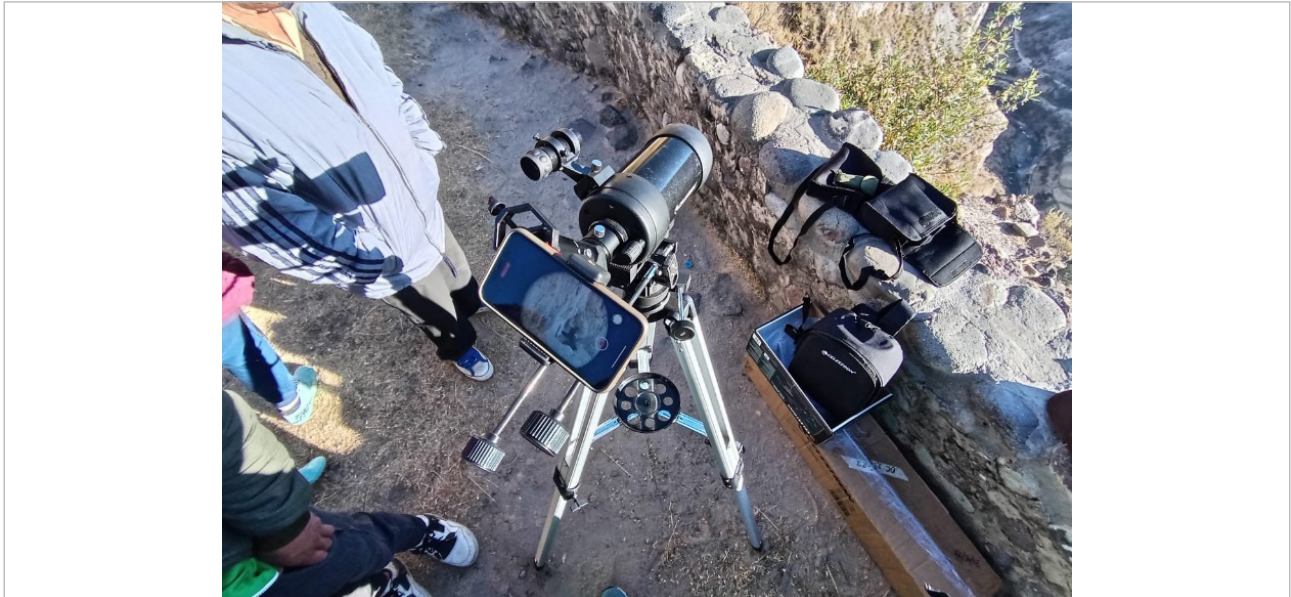
Figura 2. Telescopio adaptado a un celular
